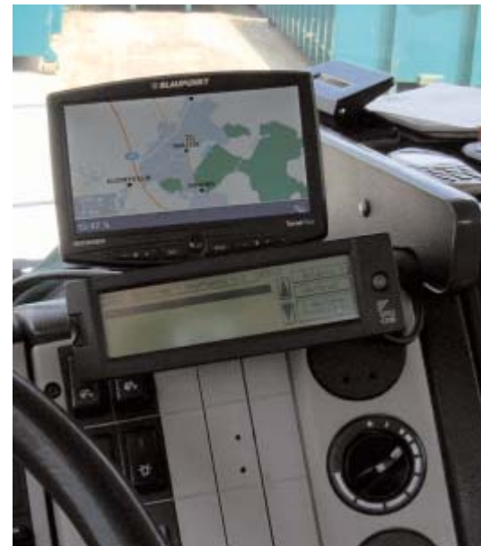
Das Telematikmodul enwis)tel übermittelt die Fahrtroute per Funk an die Fahrzeuge der GMA
