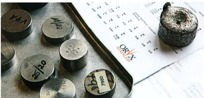
Von jeder Ladung werden Probenkörper für die Spektralanalyse angefertigt
